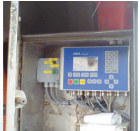
Sinnvolle Nachrüstung alter Tankwagen mit dem neuesten Boardcomputer Zevodat-flash
