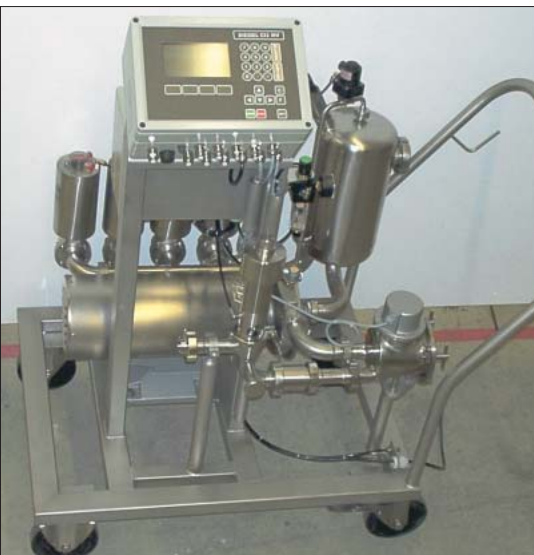
Abb. 7: Fahrbare Chargenmischanlage mit Ringkolbenzähler.
