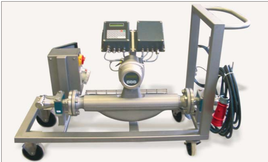
Abb. 4: Fahrbare Dosieranlage mit Massedurchflussmesser und Mengenvorwahl.
