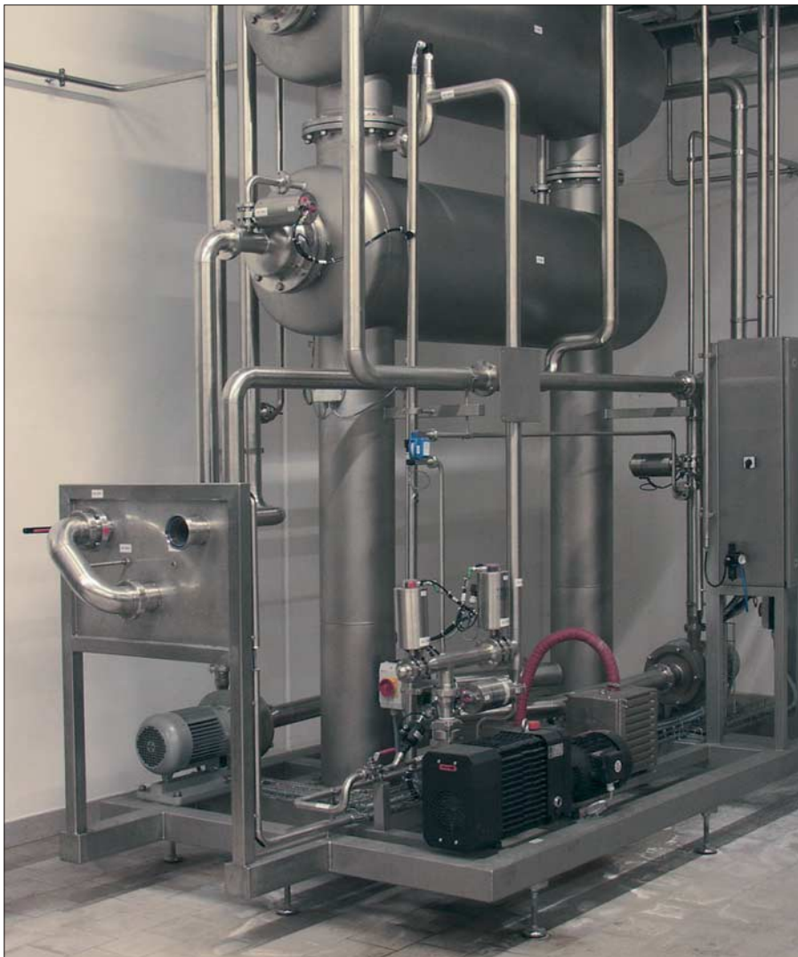
Die zweistufige Vakuumentgasungs-Anlage Diox besteht aus zwei liegenden Behältern, die übereinander angeordnet sind, einer Vakuumpumpe, einer Umwälzpumpe und einer Austragspumpe. (Fotos und Tabelle: GEA Diessel)
