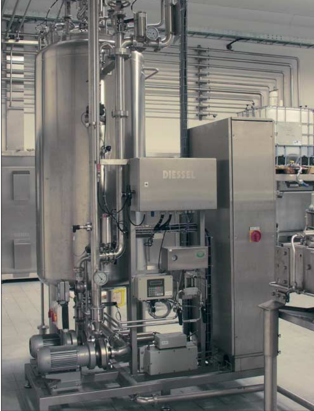
Herzstück der Karbonisieranlage ist der „Sättiger“, durch den das Gas fein verteilt der Flüssigkeit zugegeben wird. Damit das Gas in Lösung gehen kann, ist hinter dem Sättiger entweder eine Rohrleitung als Beruhigungsstrecke oder ein Drucktank installiert.
