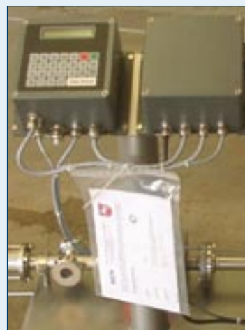
Bild 4: Messsystem IZMTE mit integriertem Hauptzählwerk (inklusive amtlichen Vorprüfschein für die Eichung)
