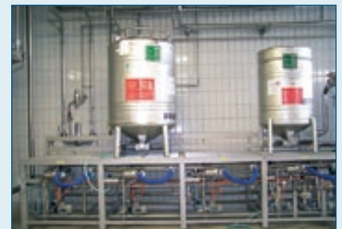
(Bild 3) Stellplätze für die Wechselcontainer mit den Zuläufen der Konzentrate zu den einzelnen Dosagelinien
