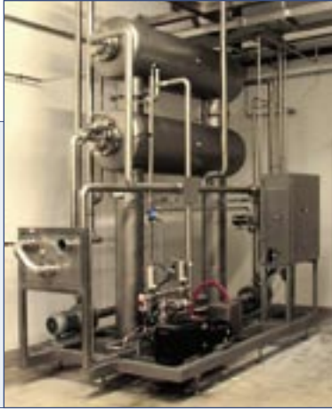
Abbildung 2: zweistufige Wasserentgasung vom Typ „DI-OX“ mit einem Restsauerstoffgehalt von weniger als 0,02 mg/L Ausmischkontrolle und Feinjustage
