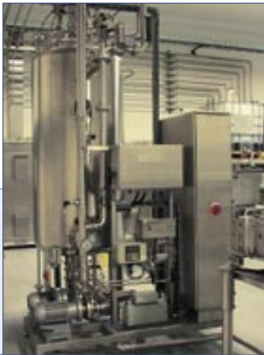
Abbildung 4: Karbonisierungsstation „DI-CAR“ für AfG-Produkten mit Analyseeinheit für Brix und CO 2
