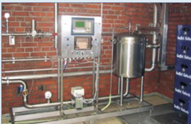
Bild 2: Amtliche Ausgabanlage für Bier mit Gasabscheider und Drucker
