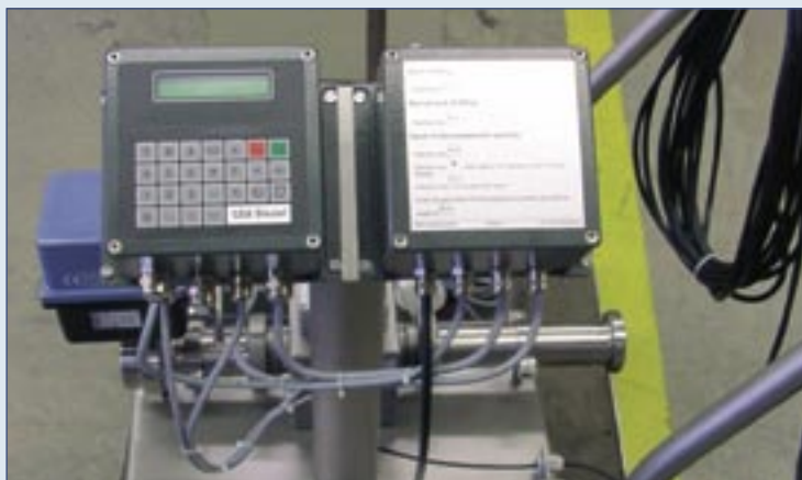
Bild 3: Fahrbare Messstation mit eingebauter Mengenvorwahl
