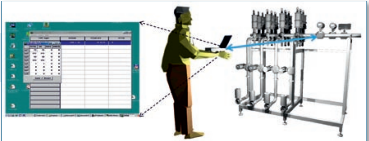
Abb. 3: kabellose Messdaten- und Parameterübertragung
