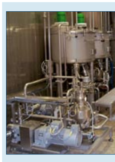
Die hohe Ausbaustufe der Chargenmischanlage kann reduziert werden, wenn zum Beispiel Konzentratcontainer nicht vorhanden sind. Es ist aber auch möglich, zusätzliche Dosierlinien hinzuzufügen. Die Chargenmischanlage ist sehr flexibel und kann problemlos an neue Produkte angepasst werden.
